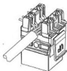
将铜线穿過压线夹子，直至固定 (T568A/T568B)
